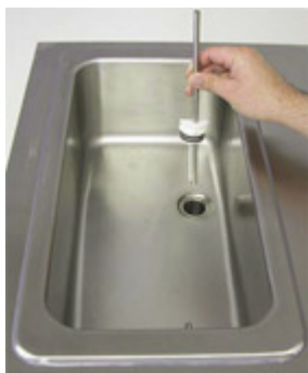
Mixbehållare med mix- och luftinblandningsrör
