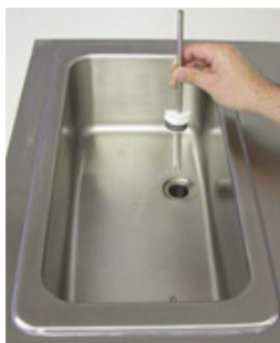
Mixbehållare med mix- och luftinblandningsrör
