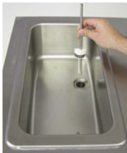
Mixbehållare med mix- och luftinblandningsrör
