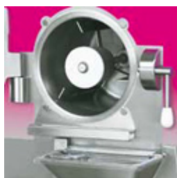
Övre kammare för pastörisering. Reglerbar upp till 105°C
